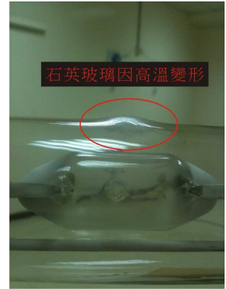
複金屬燈泡因成受不了高溫導致石英玻璃攏起變形
