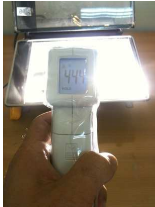
複金屬燈半個鐘頭後之中心溫度高達 44.4 度
